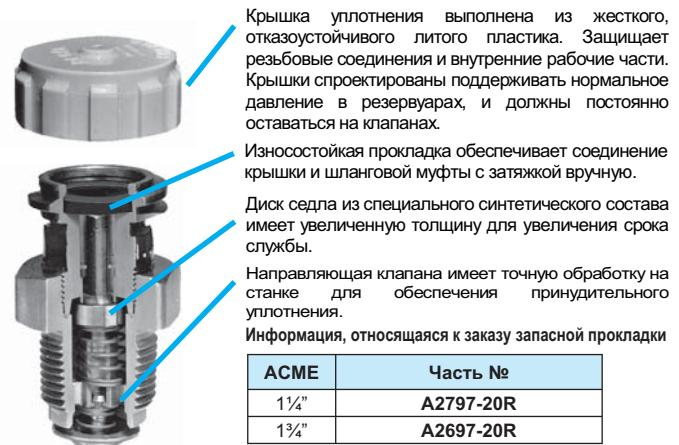
Крышка уплотнения выполнена из жесткого, отказоустойчивого литого пластика. Защищает резьбовые соединения и внутренние рабочие части. Крышки спроектированы поддерживать нормальное давление в резервуарах, и должны постоянно оставаться на клапанах.
