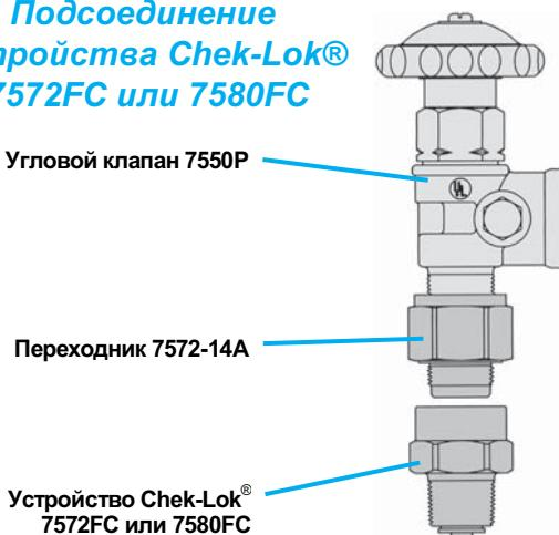
В отсутствие переключающего клапана 7550P можно использовать 3/4" шаровой клапан A7505A или угловой клапан A7506AP. Следовать вышеуказанным методикам при использовании переходника 7572C-15A вместо модели 7572C-14A. Использовать модель 7550P ECII без переходника только в аварийных ситуациях.
